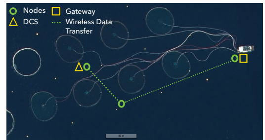
Oversikt over et oppdrettsanlegg hvor data er formidlet via et undervannsnettverk.
